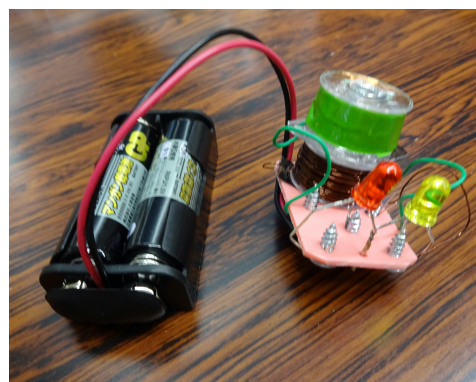
内蔵の電磁石 (サージ コイル) (ドライブ コイル)
